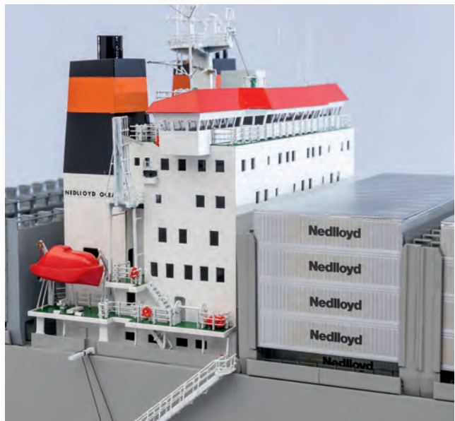
De Nedlloyd Oceania was een van de eerste containerschepen met geleiders. De containers zakken hier tussen. Een open containerschip als dit kan sneller worden geladen en gelost.
