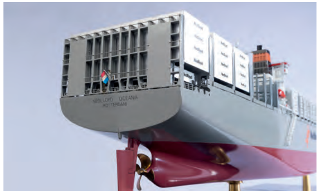
Een ruim 35.000 pk sterke Sulzer-motor zorgde voor een snelheid van 23 knopen - ongeveer 45 kilometer per uur.
